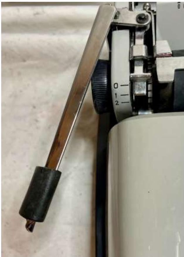
Alles sehr einfach aufgebaut. Maschine kann sehr leicht zerlegt werden. Durchdacht ist die Gummihülle über dem Zeilenschalter, sie verhindert das Zerkratzen der Maschine im Koffer 😊
