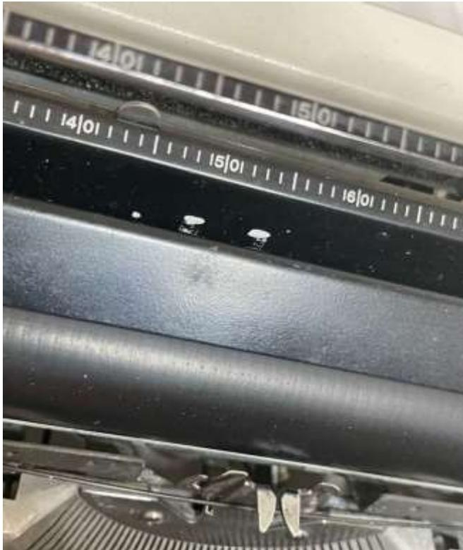
Die Zeilenlage generell habe ich mit der linken Schraube- die Lage der Groß- zu den Kleinbuchstaben mit der rechten Schraube eingestellt.
