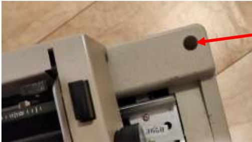
Dann die Maschine umdrehen und die beiden Schrauben links und rechts an der vorderen Unterseite abschrauben
