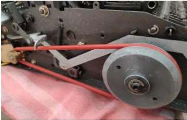
Interessant ist, dass Versuche mit Gummiringen, nur um zu prüfen ob/wie die Maschine grundsätzlich funktioniert, kein brauchbares Ergebnis gebracht haben. Die Ringerln waren offensichtlich zu klein/zu eng. Wenn der Antrieb zu eng sitzt, schlagen die Typen nicht immer auf die Walze.
