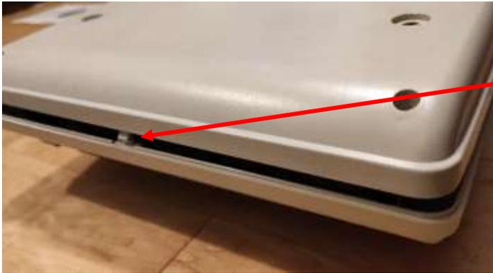
Dann kann der Gehäuseunterteil abmontiert werden.
