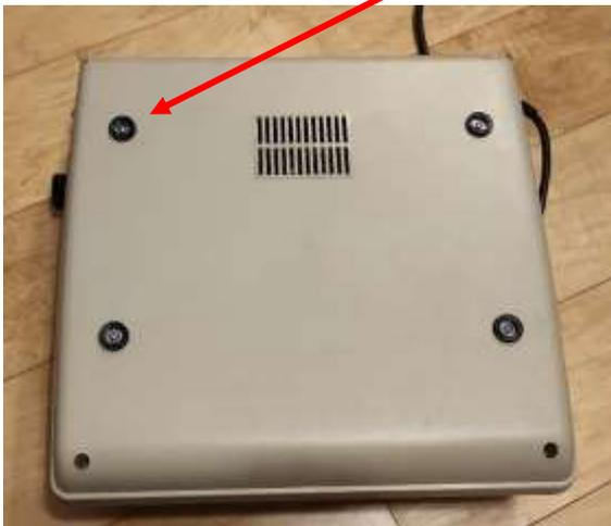
Anschließend vorsichtig mit einem flachen Schraubenzieher, vorne den Deckel anheben. Auf der Rückseite ebenso.
