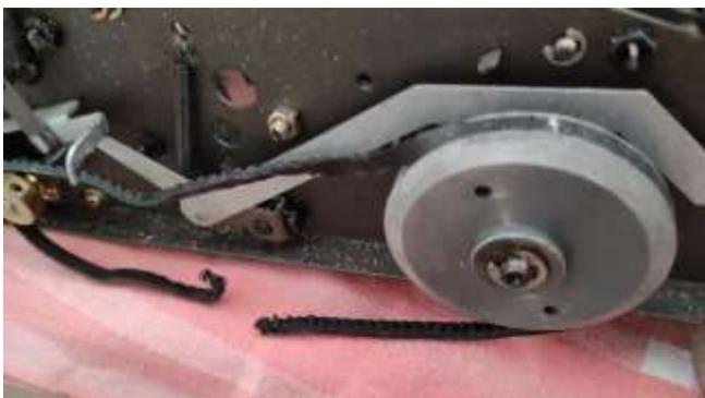
Auf Joe Van Cleaves Web Page erhielt ich in einem Video, welches auch die Demontage des Gehäuses zeigt, die Info welcher O-Ring den Keilriemen ersetzen kann. Joe sagt „eight of an inch“,  $1/8'' = \text{ca } 3\text{mm}$  und „four and a quarter in diameter“,  $4 \frac{1}{4}'' = \text{ca. } 11\text{ cm}$ .
