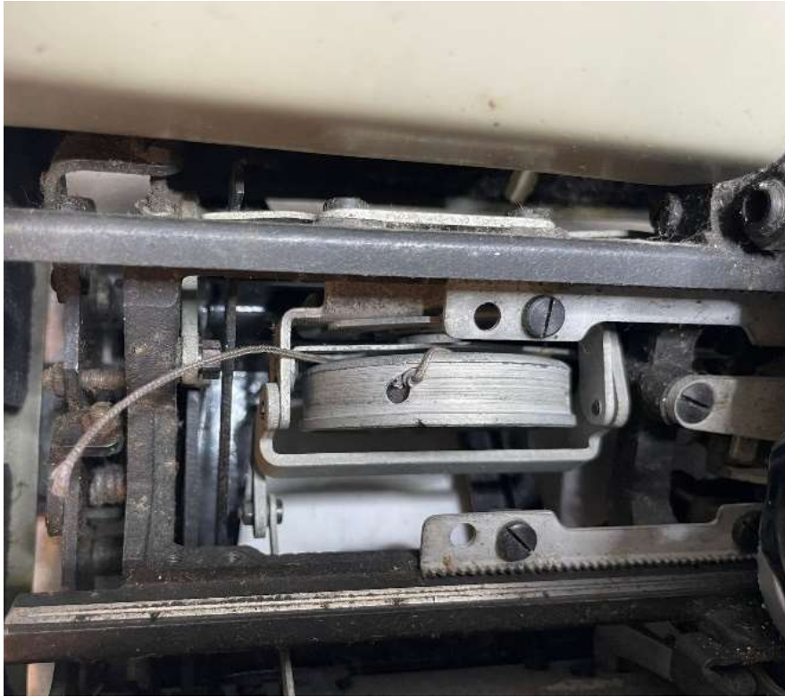
Das Zugband ist gerissen
