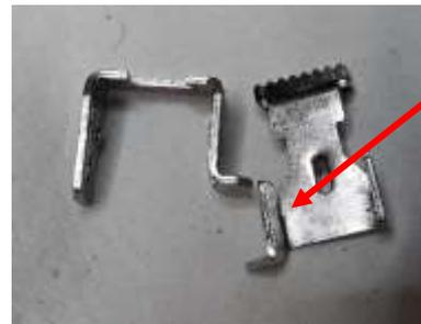
Der Wagen wird hinten, links und rechts gehalten. Wenn man den Wagen abbauen will, dann die LINKE Halterung lösen
