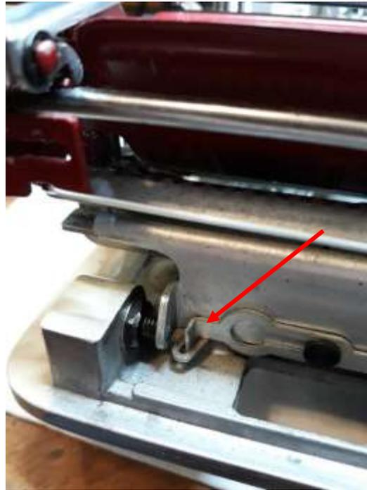
Und aufpassen muss man ebenfalls bei der Mechanik der Farbbandumschaltung!
