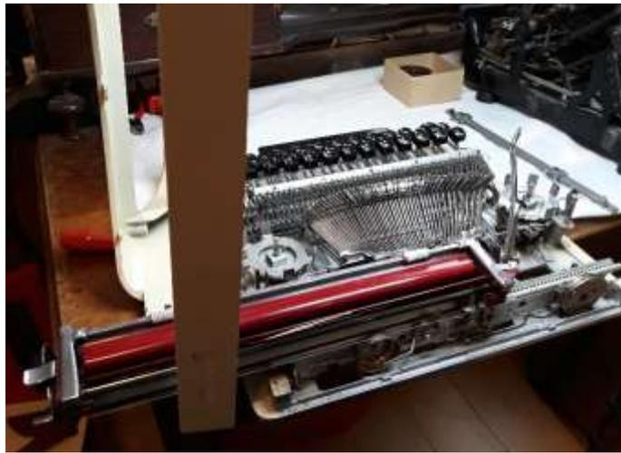
Ein Randsteller hat nicht funktioniert. Die Schiene ist links und rechts mit jeweils 2 Schrauben befestigt.
